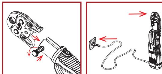
Нажмите на концы пресс-насадки, тем самым открыв губки клещей. Для выполнения пресс-соединения установите пресс-насадку на фитинг так, чтобы монтажный буртик фитинга совпал с соответствующей канавкой пресс-насадки. Обратите внимание, чтобы не было перекоса между осью инструмента и осью пресс-насадки – это может привести к опасным повреждениям.
