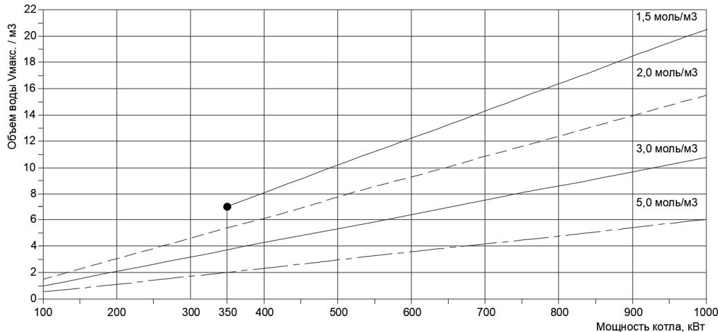
Рис. Расчетный объем воды  $V$  макс. для котлов  $\bar{Q} > 100$  кВт до  $\bar{Q} = 1000$  кВт и различных концентраций  $\text{Ca}(\text{HCO}_3)_2$ , моль/м<sup>3</sup>
