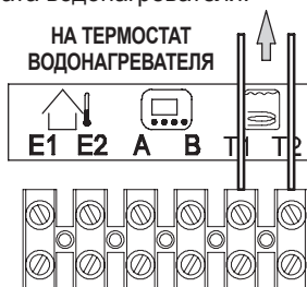
Клеммная колодка подключения термостата водонагревателя, внешнего датчика дистанционного управления
